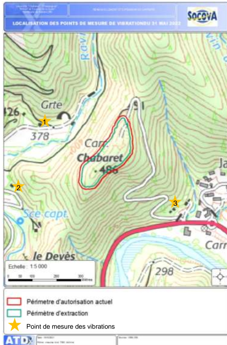
Localisation des points de mesure de vibrations du 31 mai 2022
